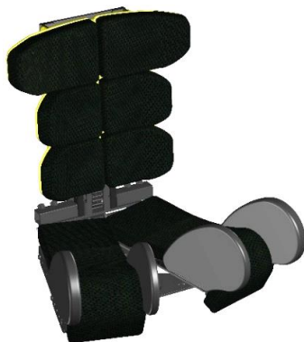
Knästöd monterade på in- och utsidan
