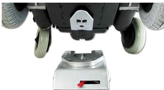
Dockningsstation och låsplatta på chassit
