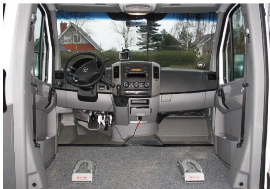
Dahl dockningsstation monterad på golvet
