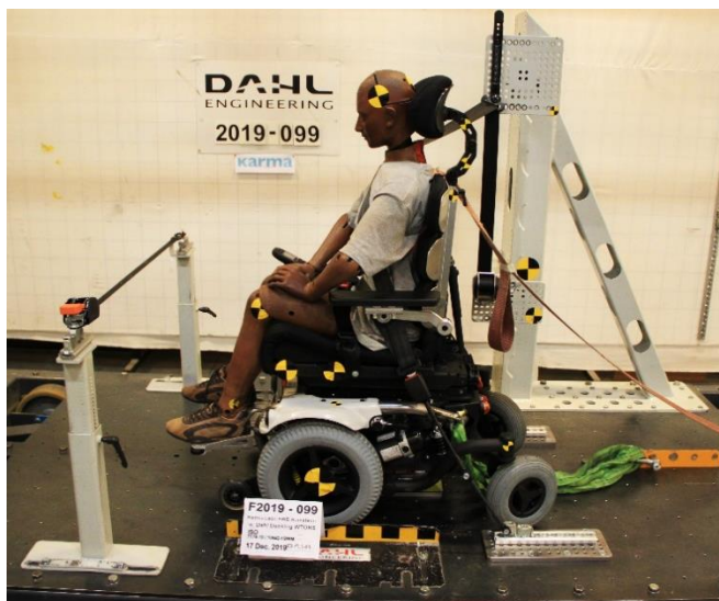
Leon F Kameleon krocktest med användning av Dahl dockningsstation
