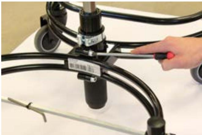
2) Bruk to 13 mm nøkler til å løsne de to gjennomgående skruene.
