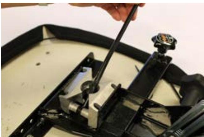
8) Sett på plass utløseren og trekk til alle skruer med 35 Nm.
