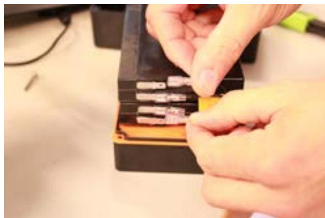
7) Løsne samtlige kabelsko og fjern batteriene. Monter i omvendt rekkefølge. Trekk til utløseren med batteriplate med 35 Nm.
