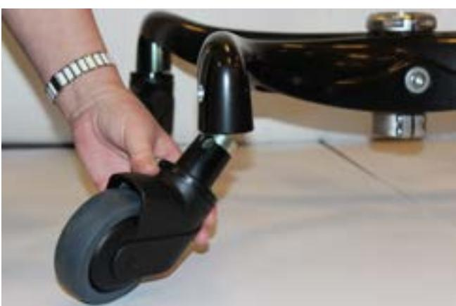
6) Bytt hjul. Husk å lime skruen og trekk til med 35 Nm. Sett alt på plass i omvendt rekkefølge.
