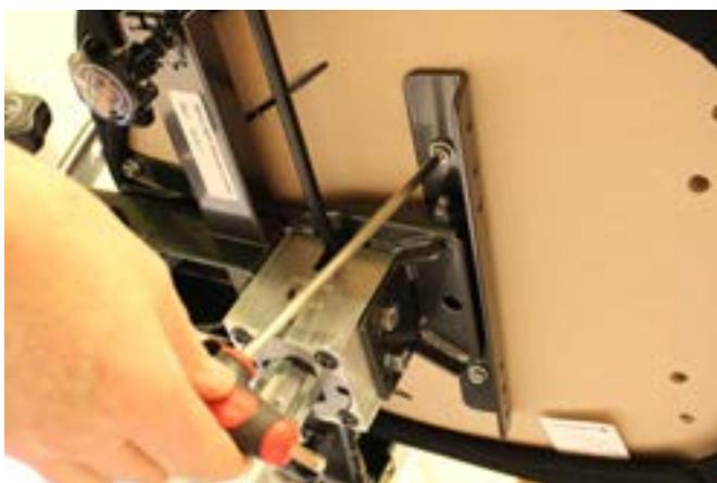
3) Skru fast alle de 6 skruene med 35 Nm.
