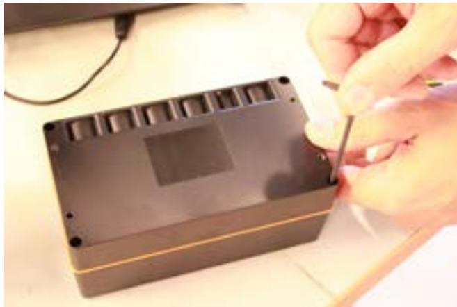
5) Løsne de fire skruene med torx T15 og snu boksen.
