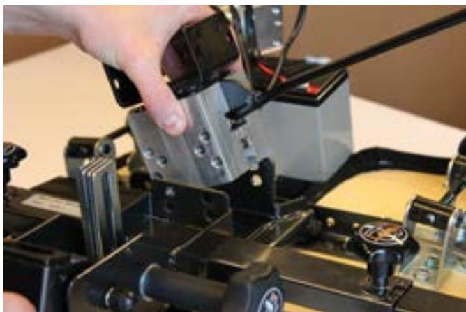
5) Løsne roteringsbakkene og bytt side. Monter i omvendt rekkefølge. Trekk til med 35 Nm.
