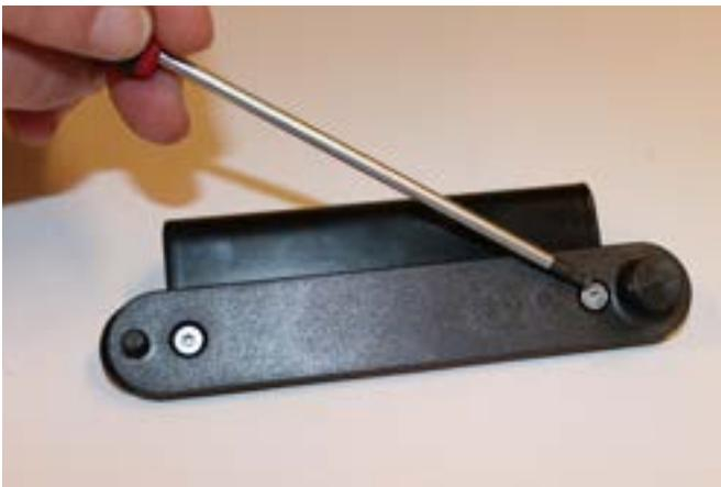
6) Løsne skruene fra metallplaten til utløseren med 2 mm sekskantnøkkel.
