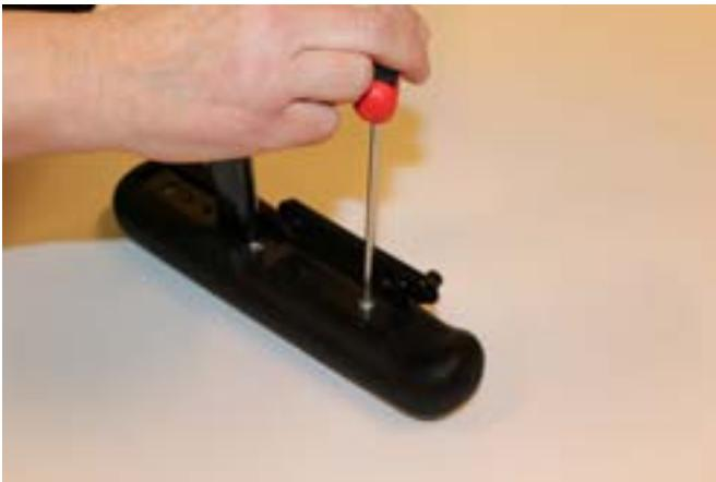
5) Skru løs to skruer på undersidan av armlenet med 5 mm sekskantnøkkel.
