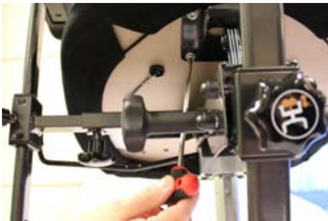
4) Pass på at alle skruene er skrudd til med 35 Nm.
