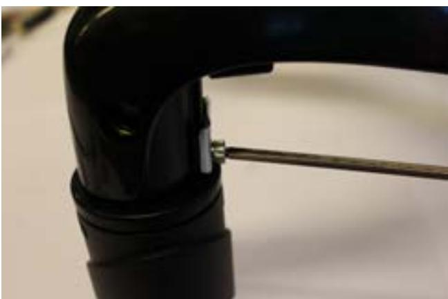
5) Løsne skruen i metallskiven med 5 mm sekskantnøkkelen.
