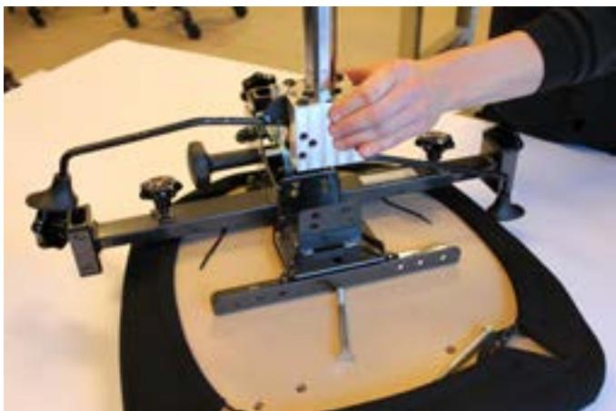
5) Monter deretter i omvendt rekkefølge. Pass på at stolsetet plasseres riktig i chassiset. Skru fast de to M8-skruene i chassiset med 35 Nm.
