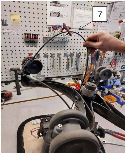
8. Desserrer les roulettes sur le côté de la jambe où se trouve le câble.
