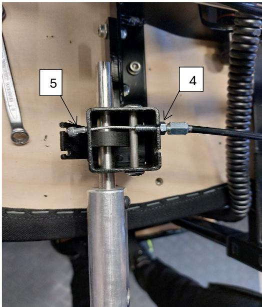
6. Dévisser la vis de réglage et sortir le câble du logement du frein.
